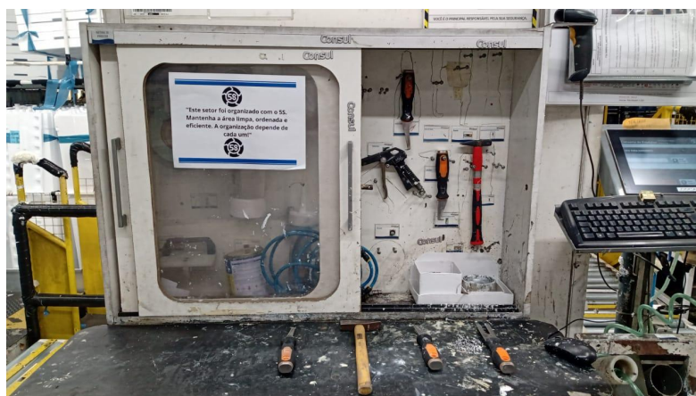
Figura 11 – Bancada com ferramentas e materiais antes da aplicação do 5S
