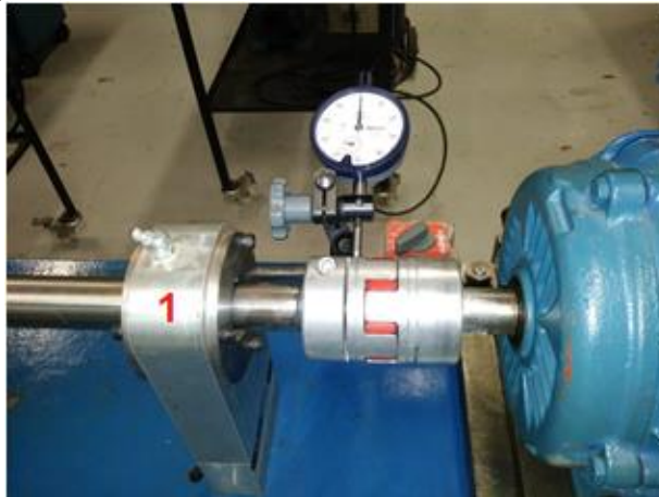
Figura 19 – Alinhamento dos eixos do mancal e motor
