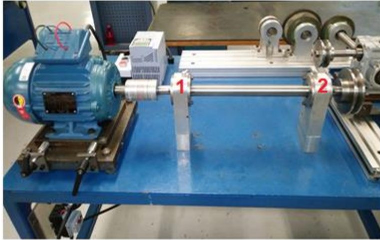
Figura 16 - kit didático para tarefas de alinhamento e balanceamento.
