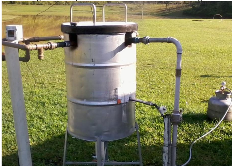
Figura 7 - Dispositivo de ensaio de resistência ao fogo
