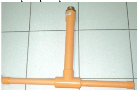
Figura 6 - Corpo de prova para ensaio de resistência ao fogo
