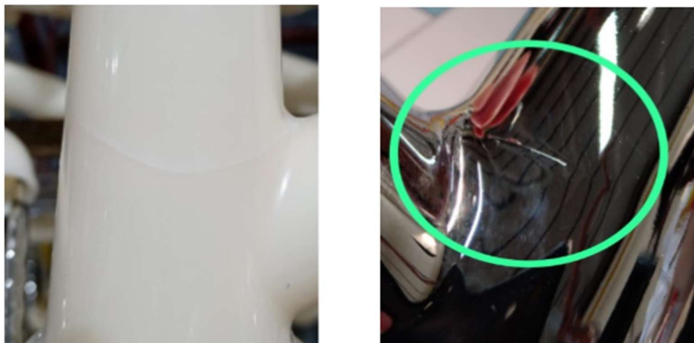
Figura 3. Defeitos em ABS Natural - Tensionamento
