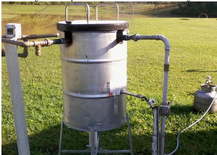
Figura 7 - Dispositivo de ensaio de resistência ao fogo
