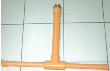
Figura 6 - Corpo de prova para ensaio de resistência ao fogo
