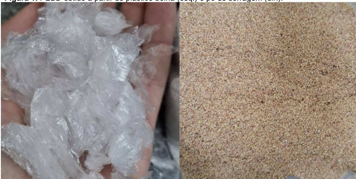
Figura 1. PEBD obtido a partir de plástico bolha (esq.) e pó de serragem (dir.).
