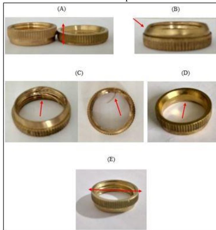
Figura 07: Tipos de Insertos Não Conforme. (A) Inserto com Perfil Abaixo do Especificado. (B) Inserto Deformado. (C) Inserto com a Rosca Danificada. (D) Inserto sem Rosca. (E) Inserto com Diâmetro Fora das Tolerâncias Especificadas
