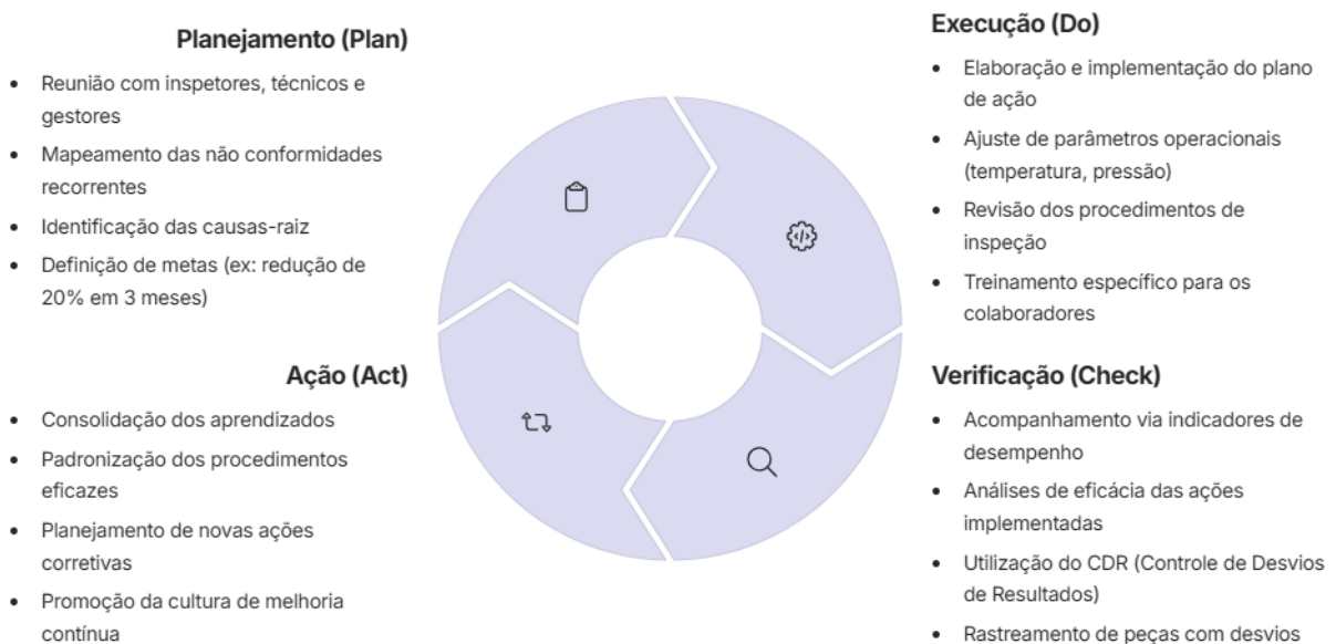
Figura 2. Simulação Teórica da Aplicação do PDCA no Processo Produtivo
