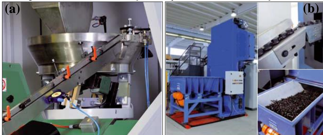
Figura 2 - (a) Sistema de alimentação da máquina (b) sistema de alimentação vertical
