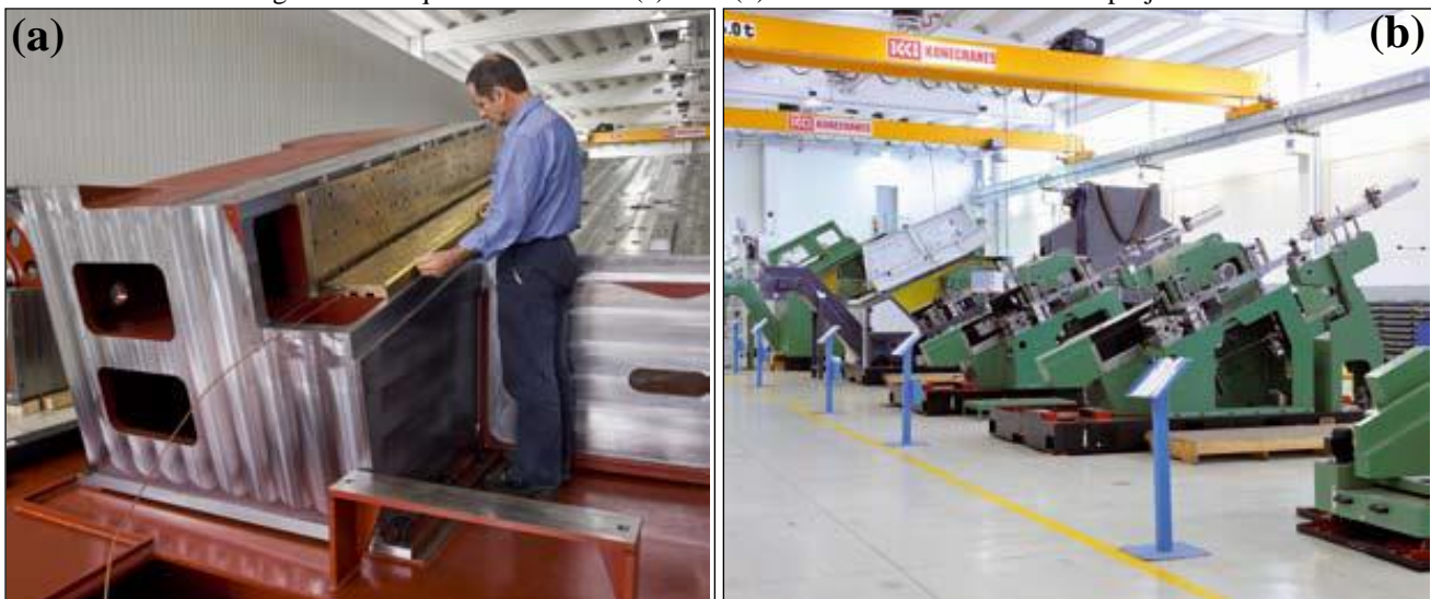
Figura 1 – Máquina laminadora: (a) base (b) sistema de modularidade do projeto
