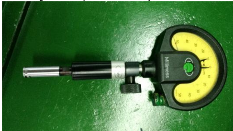
Figura 12 - Dispositivo de verificação de vazamento
