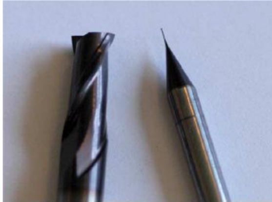
Figura 4 - Diferenças entre uma fresa convencional com 6mm de diâmetro e uma microfresa com 0,2mm de diâmetro
