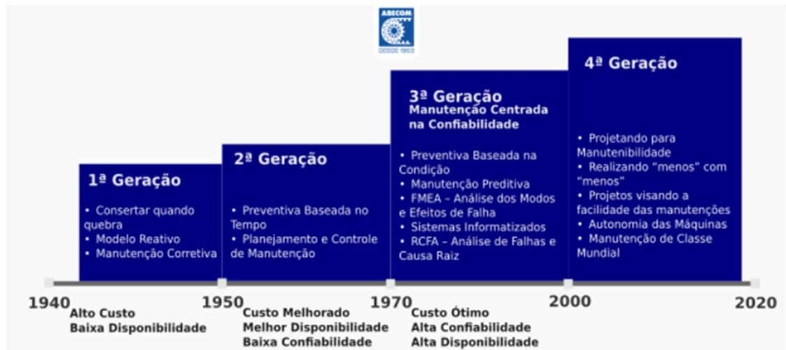
Figura 1. Evolução das Técnicas de Manutenção
