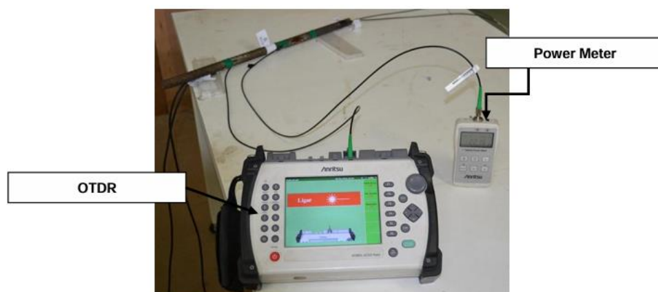
Figura 15. Inspeção da fibra óptica pelo aparelho OTDR e Power Meter
