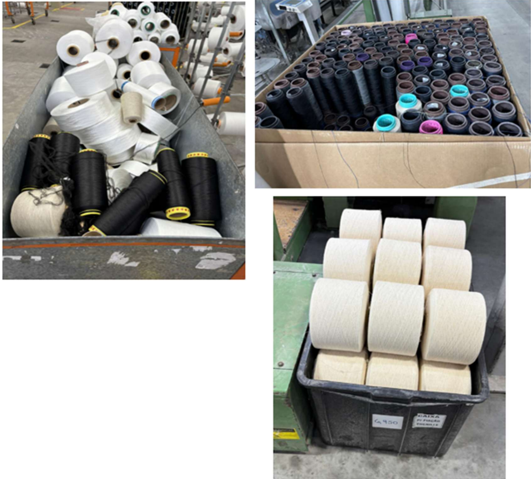
Figura 20. ANTES e DEPOIS da implantação do 5S: organização dos fios
