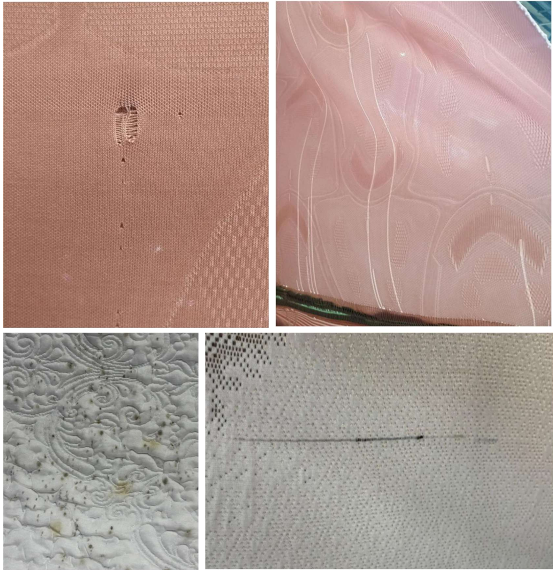
Figura 13. Sujeiras no tear causam riscos e falhas na Malharia
